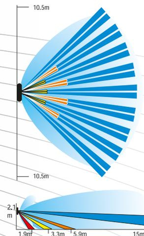
Il SYRIO W DT07 è un rivelatore volumetrico antintrusione a doppia tecnologia Microonda (MW) e Infrarosso Passivo (IRP) con antimascheramento della sezione microonda. Destinato ad installazioni altamente professionali, si distingue per le sue importanti caratteristiche quali: Antimascheramento sulla Microonda con uscita a relè; AB-funzione antiaccecamento sull' Infrarosso; ECO-possibilità di spegnimento della Microonda; staffa MINILINK per installazione a parete/soffitto in dotazione.
